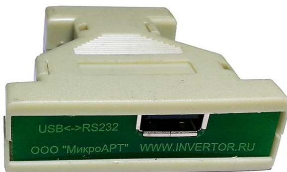
**Переходник USB – RS-232** – высокоскоростной конвертер, позволяющий подключить устройство по RS-232 к USB-порту компьютера. Конвертер гальванически развязан, что обеспечивает защиту оборудования.
